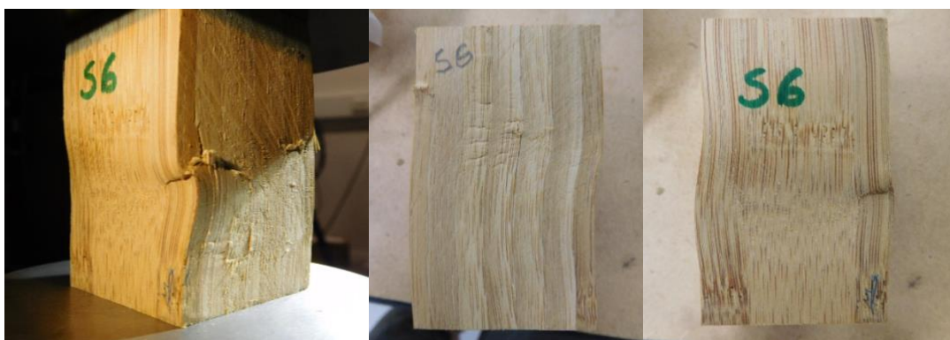
Figura 8. Probetas de bambú laminado ensayadas en la universidad de Queensland en donde falla se encuentra gobernada por la falla por aplastamiento del bambú.
