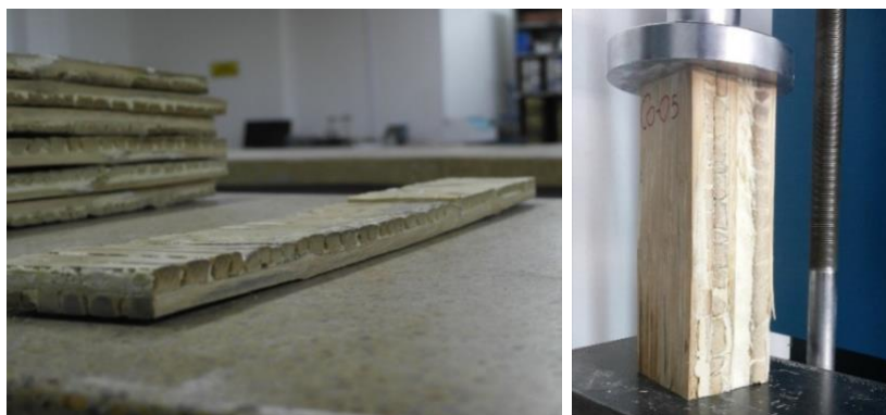
Figura 2. Laminado de guadua para las probetas del ensayo a flexión (izquierda) y compresión (derecha)
