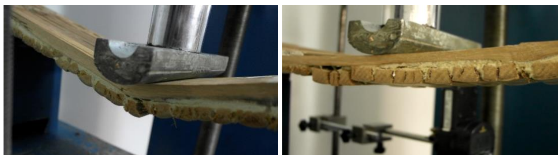
Figura 10. Falla a flexión para probetas T2 donde se evidencia falla a tracción y cortante del pegante en la parte inferior y en la mitad de la altura de la probeta.
