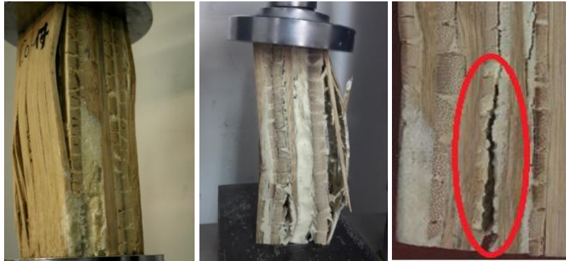
Figura 7. Tipos de falla en las probetas sometidas a compresión evidenciando pandeo local de las láminas de esterilla y falta de adherencia entre las capas de esterilla.
